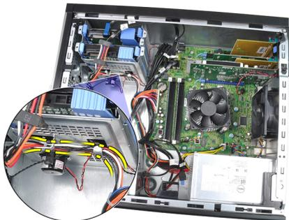
5. Desconecte el cable de alimentación de 24 patas de la placa base.
