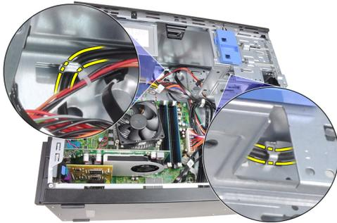
7. Suelte el cable del interruptor de alimentación del gancho del chasis.
