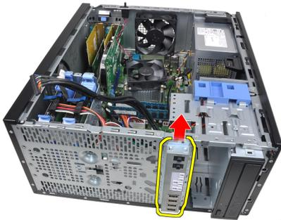
8. Quite el panel de entrada/salida colocando el cable a través de la parte frontal de equipo.
