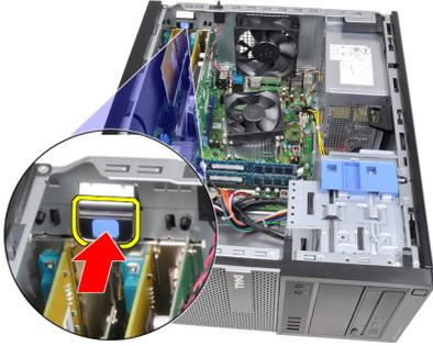
4. Tire de la palanca de liberación de la tarjeta PCIe x16 para que se suelte la pestaña de fijación de la hendidura de la tarjeta. Después deslice la tarjeta para sacarla de su conector y extraerla del equipo.
