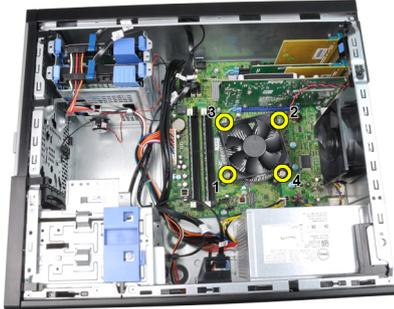
5. Levante el ensamblaje del disipador de calor y sáquelo del equipo. Apóyelo con el ventilador mirando hacia abajo y con la grasa térmica hacia arriba.
