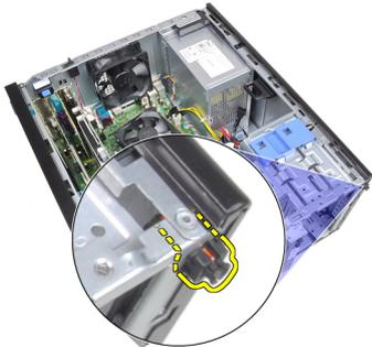
9. Saque el cable del interruptor de alimentación a través de la parte frontal del equipo.
