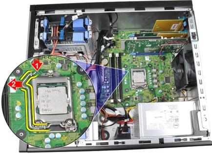
7. Coloque la cubierta del procesador.
