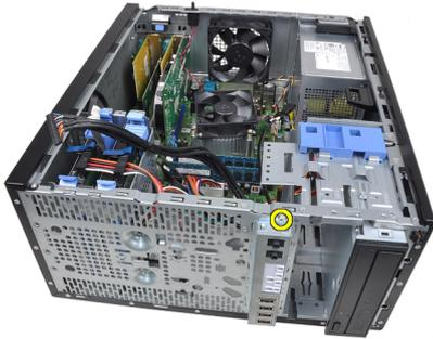
7. Deslice el panel de entrada/salida hacia la izquierda del equipo y suéltelo.
