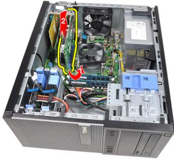
5. Deslice la tarjeta de expansión PCIe x1 (si la hay) para sacarla de su conector y extraerla del equipo.
