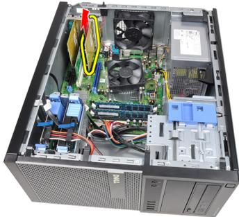
6. Deslice la tarjeta de expansión PCI (si la hay) para sacarla de su conector y extraerla del equipo.
