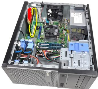
7. Deslice la tarjeta de expansión PCI x4 (si la hay) para sacarla de su conector y extraerla del equipo.
