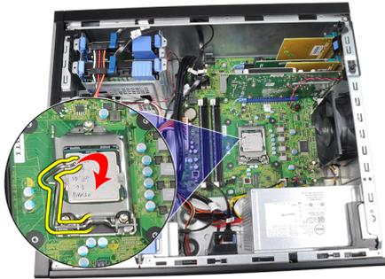
8. Levante el procesador para retirarlo del zócalo y colóquelo en un embalaje antiestático.
