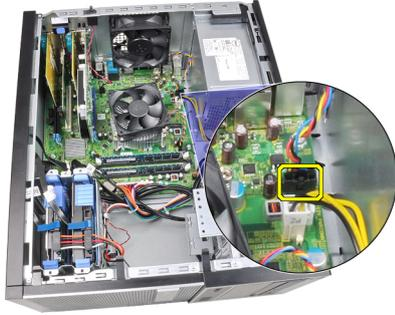
4. Levante y saque el ventilador del sistema de los cuatro aros que lo sujetan a la parte posterior del equipo.
