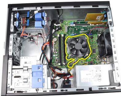
6. Presione la palanca de liberación y muévela hacia fuera para liberarla del gancho de retención que la mantiene fija.
