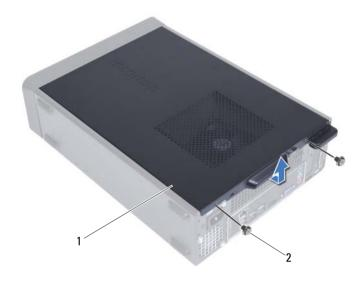
1 крышка корпуса компьютера 2 винты (2)
