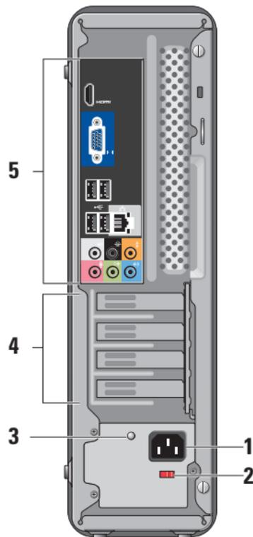
**1 Conector de alimentación:** se utiliza para conectar el cable de alimentación. Su aspecto puede variar.
