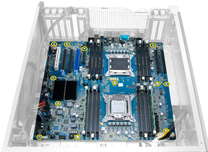
5. Heben Sie die Systemplatine nach oben aus dem Gehäuse heraus und entfernen Sie sie aus dem Computer.
