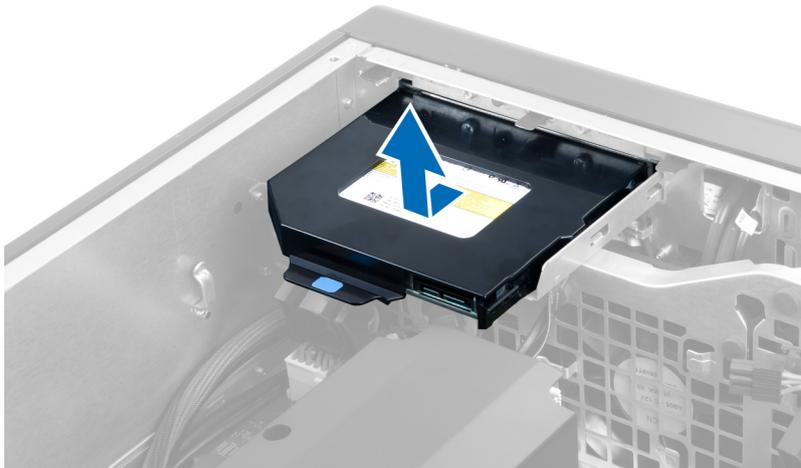
7. Biegen Sie die Riegel an der Halterung des optischen Laufwerks nach außen, um das optische Laufwerk aus der Halterung zu lösen.
