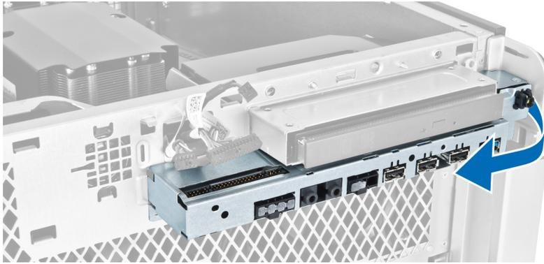
6. Schieben Sie die gegenüberliegende Seite der vorderen E/A-Leiste nach außen, um das E/A-Modul aus dem Gehäuse zu lösen.
