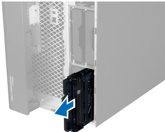
5. Falls ein zweites Festplattenlaufwerk installiert ist, ziehen Sie die Schnalle der zweiten Festplattenlaufwerkhalterung nach außen.
