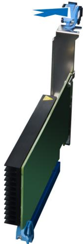
4. Drücken Sie den Hebel nach unten und ziehen Sie die PCI-Karte aus dem Computer.
