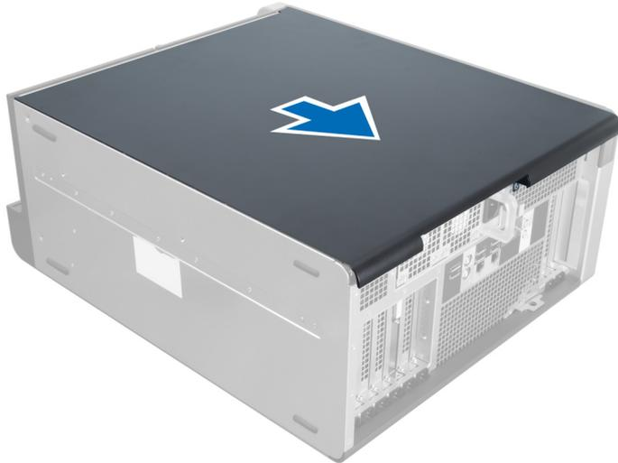
4. Heben Sie die rechte Abdeckung um 45 Grad an und entfernen Sie sie vom Computer.
