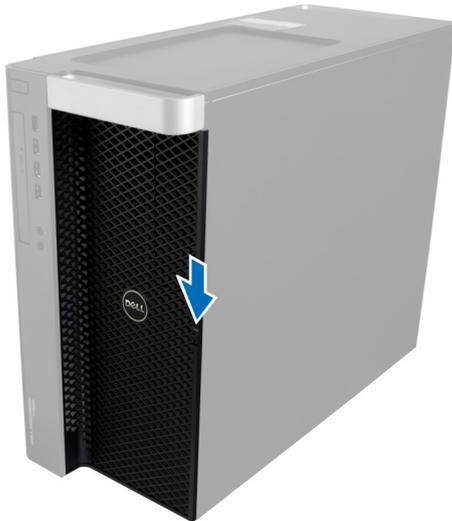
3. Drücken Sie den Riegel weiter nach unten und ziehen Sie die vordere Abdeckung nach außen, um Sie aus dem Computer zu entfernen.
