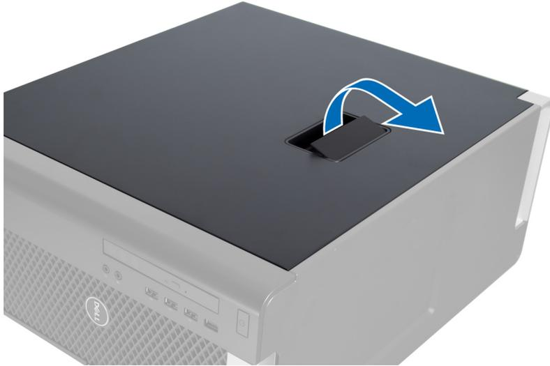
3. Heben Sie die Abdeckung in einem Winkel von 45 Grad an und entfernen Sie sie vom Computer.
