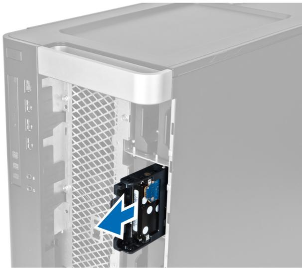
7. Biegen Sie die Festplattenlaufwerkhalterung auf beiden Seiten, um das Festplattenlaufwerk zu lösen.
