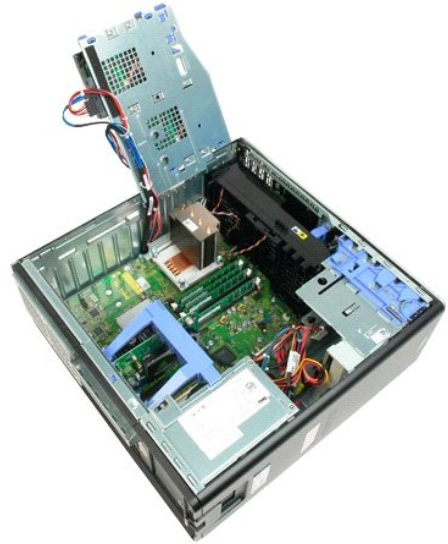
5. قم بترك مسامير التثبيت الأربعة الموجودة على مجموعة امتصاص الحرارة.
