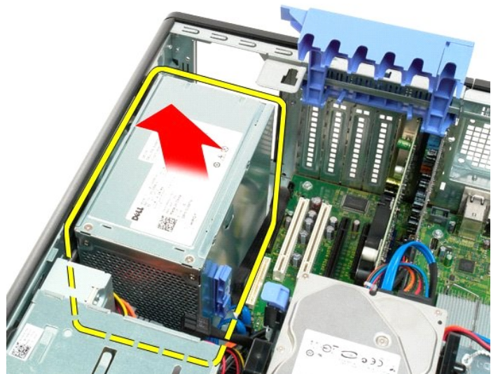
8. ارفع وحدة الإمداد بالطاقة مباشرة لأعلى وأزلها من الكمبيوتر.
