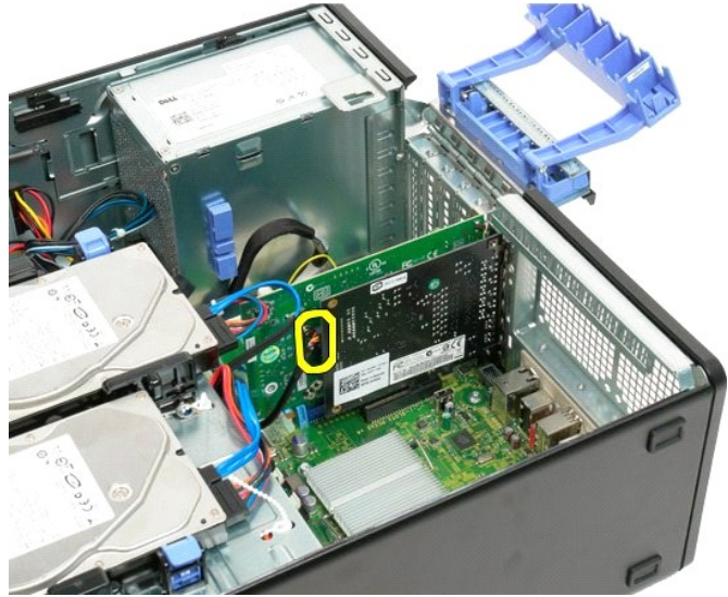
7. ارفع بطاقة التمديد مباشرة لأعلى وقم بإزالتها من الكمبيوتر.
