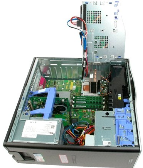
5. باستخدام إبهامك، اضغط برفق إلى الأسفل على مشابك احتجاز وحدة الذاكرة على أي طرف من طرفي الوحدة لتحرير الوحدة من موصل لوحة النظام.
