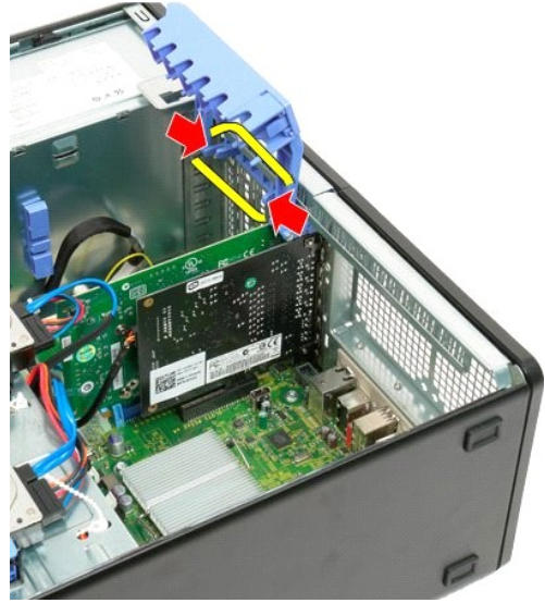
5. تابع سحب ذراع احتجاز بطاقة التمديد تجاه الجزء الخارجي من الكمبيوتر.
